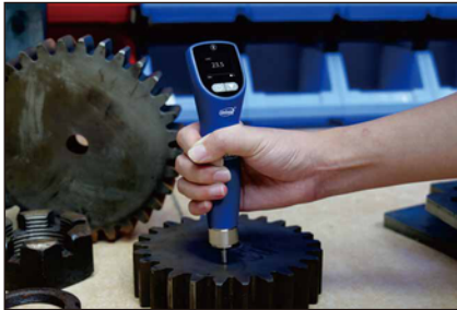
Prueba de la superficie de engranajes pequeños
